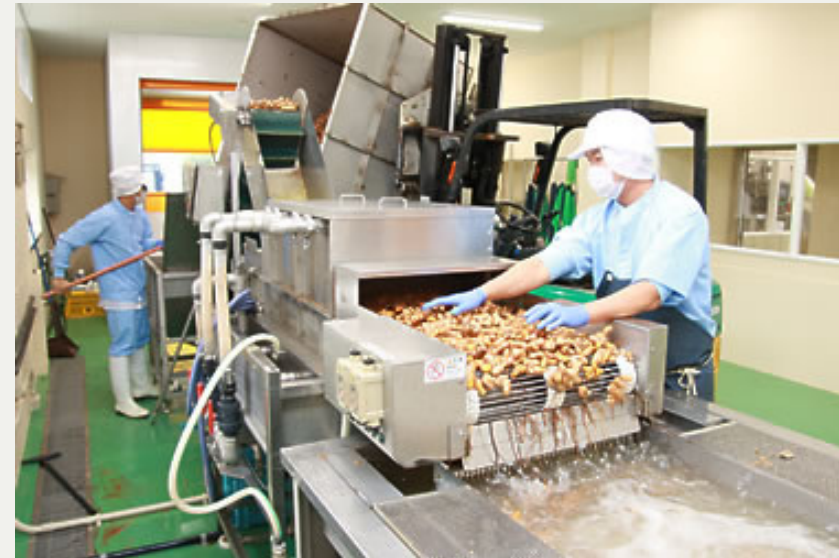
2. Lavaggio con acqua Kangen pH 11.5 e ridotta in pressione elevata attraverso il tunnel della lavatrice.
