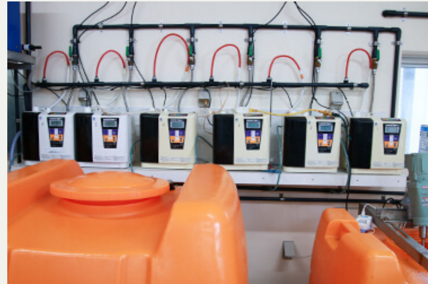
4. Trattamento di sterilizzazione con acqua acida con il pH 2.5
