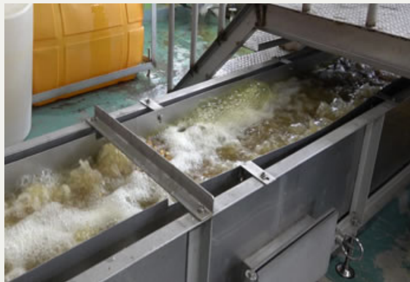
4. Trattamento di sterilizzazione con acqua acida con il pH 2.5
